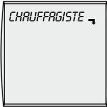
Appuyez sur le bouton rotatif droit pour passer au 2ème niveau d'utilisation. En tournant le bouton rotatif droit dans le sens des aiguilles d'une montre, sélectionnez le menu « Chauffagiste » puis appuyez de nouveau sur le bouton rotatif droit pour confirmer votre choix.
