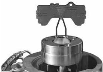
**18. 3<sup>ème</sup> contrôle : l'intervalle entre les électrodes d'allumage est-il correct ?**
