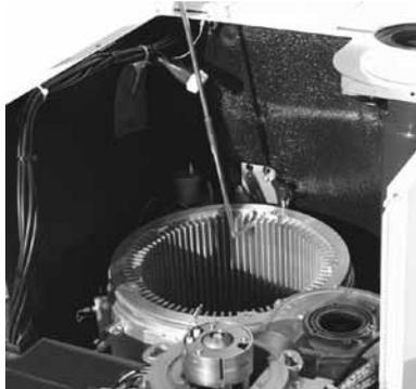
25. Imbiber les incrustations tenaces avec de l'eau pendant au moins 2 minutes. Dévisser la tête de brossage de la poignée et la remplacer par le crochet de nettoyage. Gratter ensuite les incrustations avec le crochet de nettoyage. Permuter à nouveau les embouts de nettoyage et suspendre la brosse de nettoyage au panneau arrière.
