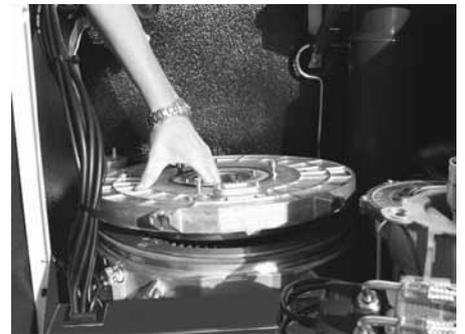
21. Retirez et déposez le couvercle de la chambre de combustion.
