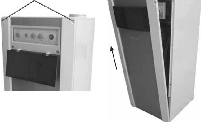
4. Desserrer les vis à gauche / à droite, tirer l'habillage frontal vers l'avant et le soulever.
