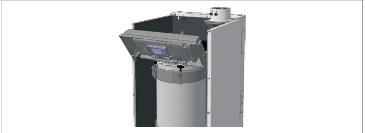
Illustration 6.5 Rabattre le boîtier de régulation
